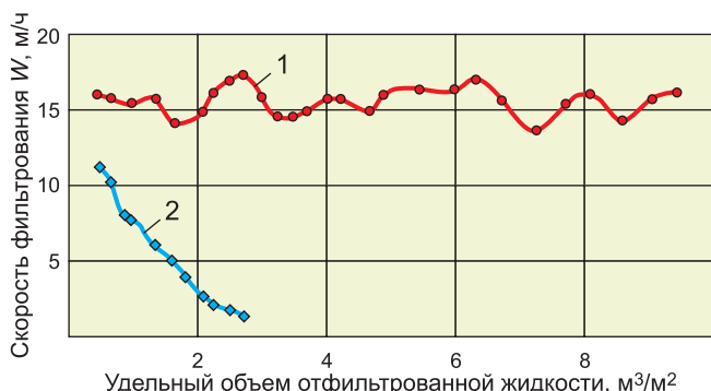
Рис. 7. Зависимость скорости фильтрации W от объема отфильтрованной жидкости, отнесенного к единице поверхности фильтрующего элемента q 1 – СФЭ; 2 – металлокерамический элемент
